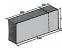
F31 Formziegel für zwei Passstücke
